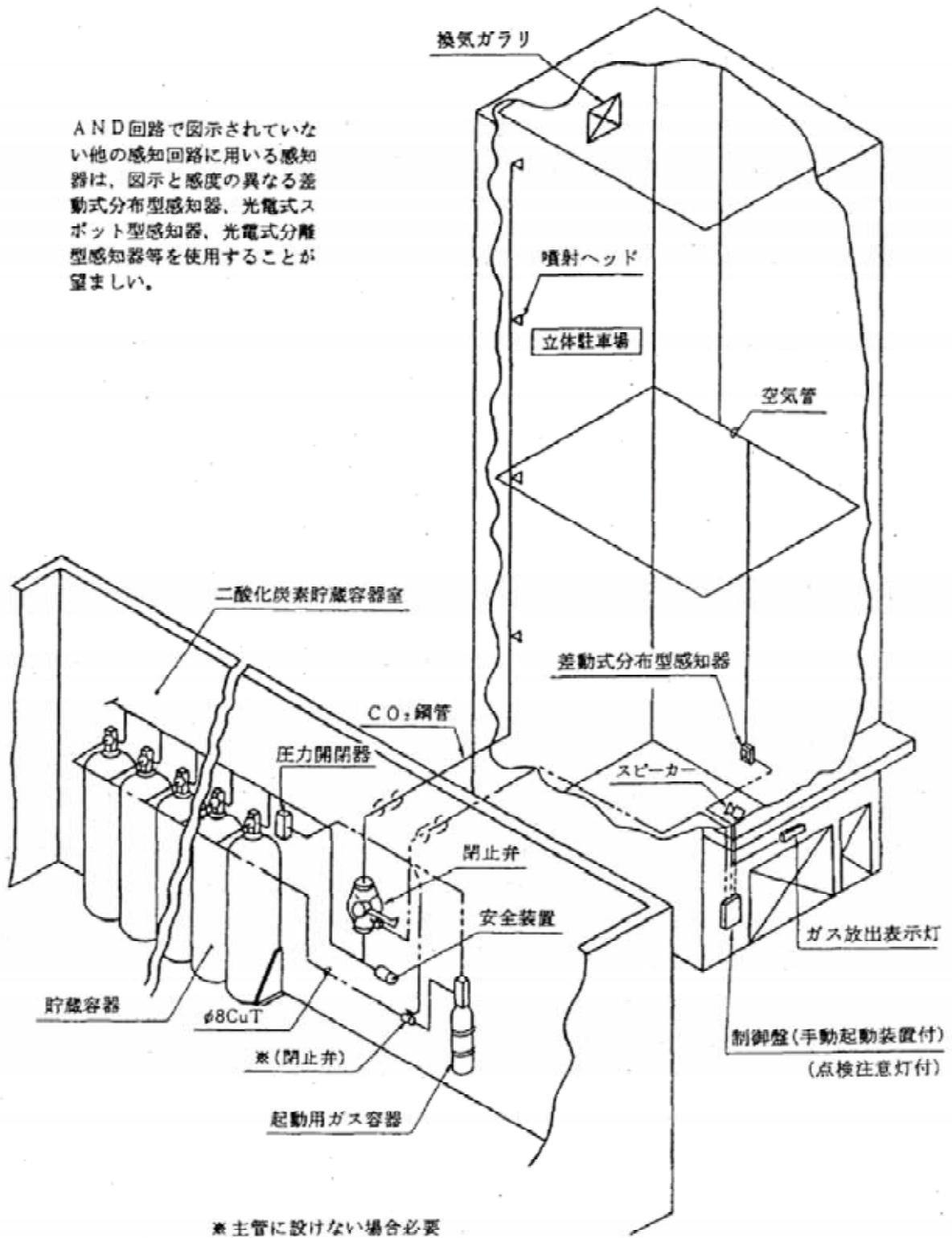
第2図 二酸化炭素消火設備系統図
