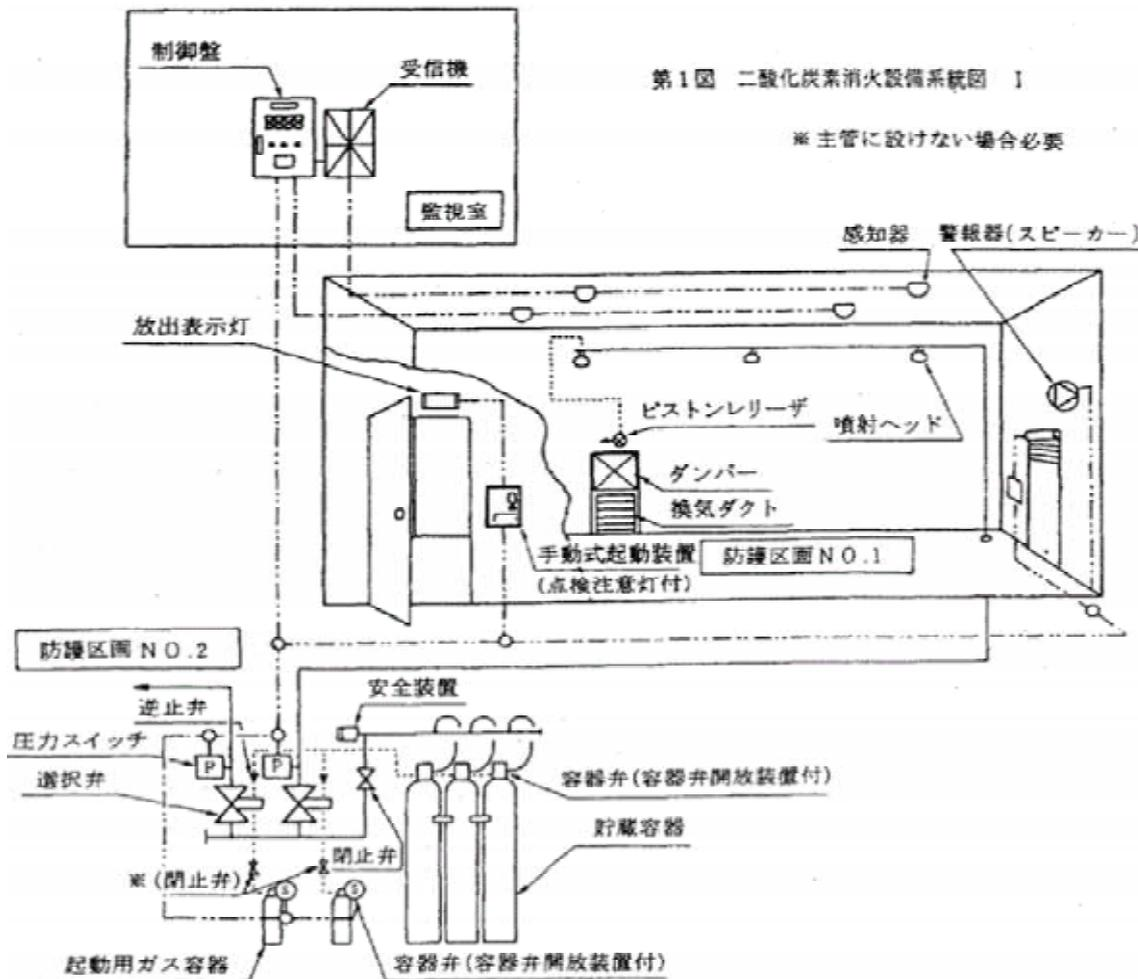
第1図 二酸化炭素消火設備系統図 1
